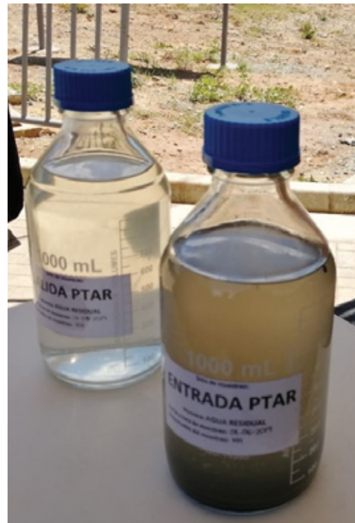
Figura 12 Resultado del tratamiento de las aguas residuales en la Planta de Niquía Foto del autor
