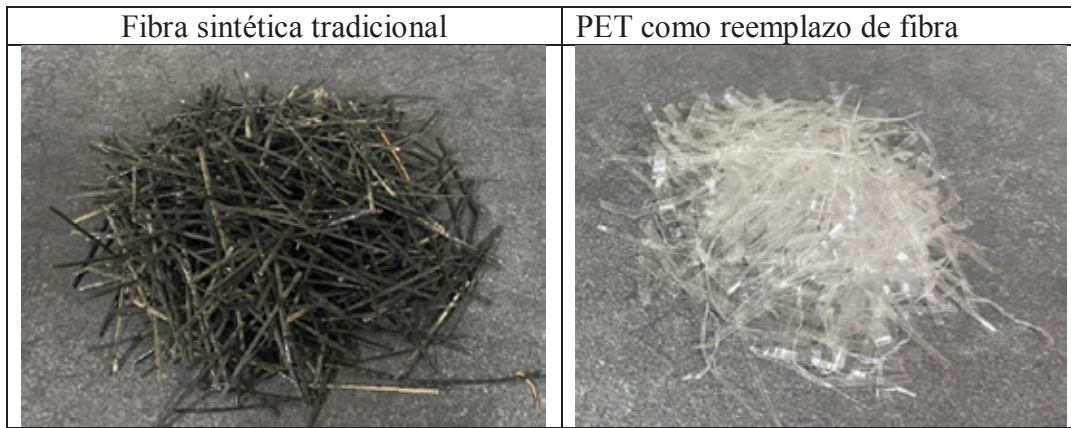
Figura 4. Comparación de fibra sintética con PET triturado Elaboración propia
