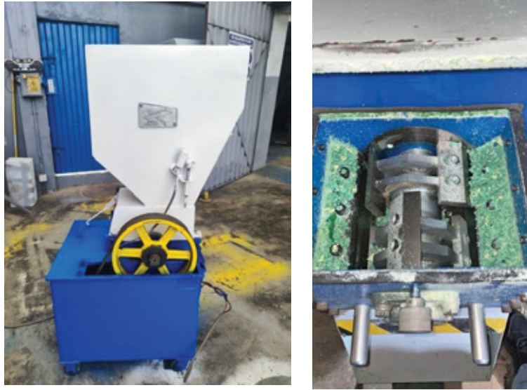
Figura 6. Vistas externa e interna de la trituradora de botellas PET Elaboración propia
